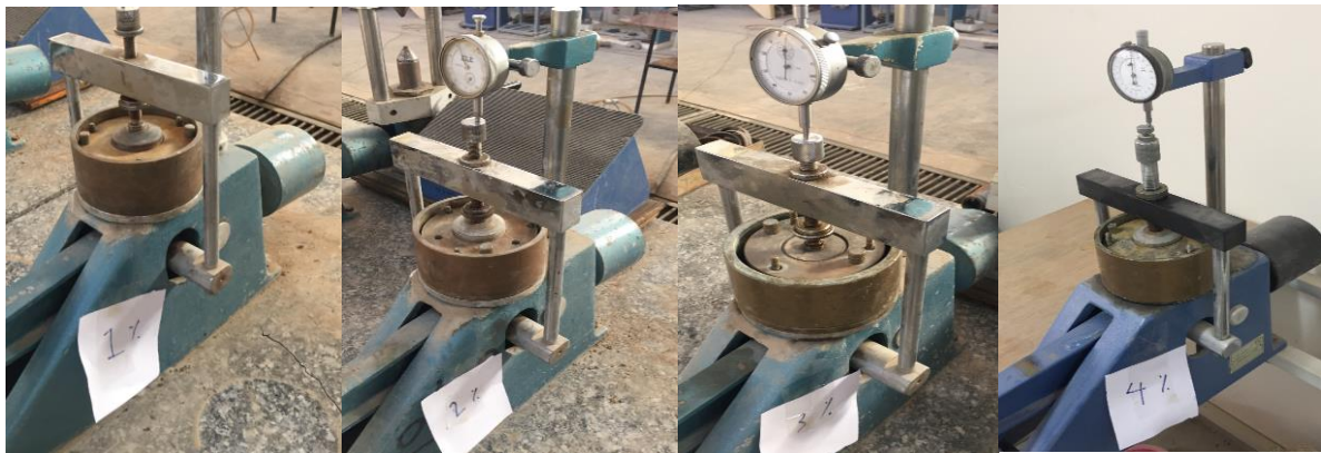
شکل ۱۰. نمونه های خاک با درصدهای متفاوت آلژینات سدیم در آزمون تحکیم منفرد
