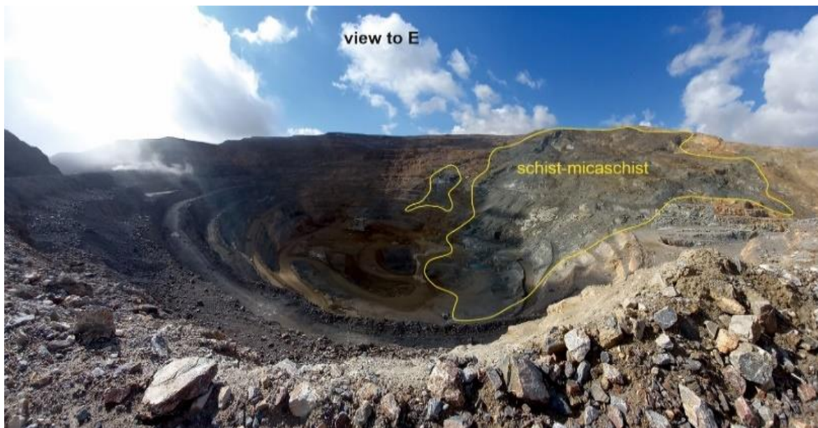
شکل ۲. نمایی از قسمت شیست و میکاشیست در معدن انگوران و مرز بین شیست ها و کربنات های پیت معدن انگوران.
