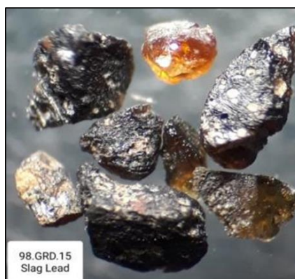
شکل ۱۰، تصویری از حضور سرباره شیشه ای سربی در نمونه GRD.15
