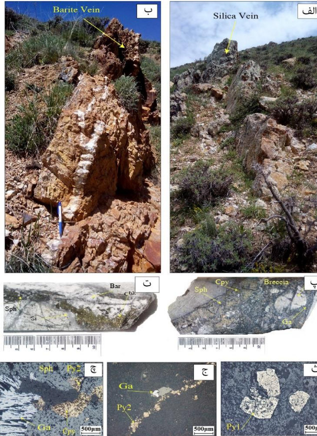
شکل ۷- تصاویر صحرایی، نمونه‌های دستساز از مغزه‌های حفاری و مینرالوگرافی (XPL) از بخش کانی‌زایی آلچاق‌شلاق در الف) رگه سیلیسی کانه‌دار (دید به سمت شمال شرقی)، ب) رگه باریتی (دید به سمت شمال غربی)، پ) کانی‌زایی اسفالریت، گالن، کالکوپیریت و پیریت در بافت برشی مغزه حفاری با سنگ میزبان داسیت آندزیتی. ت) کانی‌زایی غالب کالکوپیریت، اسفالریت و گالن در مغزه حفاری با باطله سیلیسی-کلسیتی (ث) پیریت نسل اول که در آن قطعات درشت که در اثر فرایندهای تکتونیکی بعدی دچار شکستگی و جابجایی شده است. ج) کانی رگه‌های پیریت نسل دوم و کانی گالن در مرحله دوم کانی‌زایی (چ) کانی‌های اسفالریت، کالکوپیریت و گالن مرحله دوم کانی‌زایی. علائم اختصاری کانی‌ها از ویتنی و اوانز [22] اقتباس شده است (Sph: اسفالریت، Py: پیریت، Ga: گالن، Cpy: کالکوپیریت).
