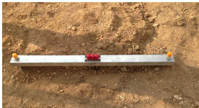
شکل ۶. نمونه اکتانوسومتر درون چاهی
