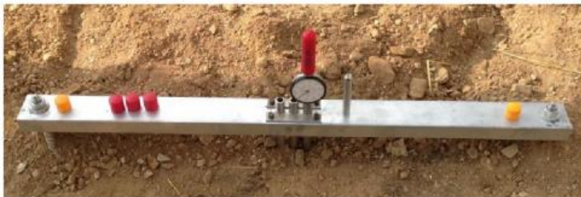
شکل ۱۰. پین نشست سنجی تعبیه شده بر روی کله‌ی
