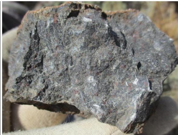
شکل ۱۴. نمونه دستی همراه با نمای میکروسکوپی آن در نور پلاریزه. بافت پورفیریتیک با زمینه میکروکریستالین است که فنوکریست‌های پلاژیوکلاز و کلینوپیروکسن در زمینه ریزلور شامل فلدسپات و کانیهای تیره تشکیل شده اند (نور XPL)..
