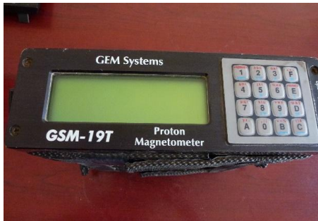
شکل ۳. دستگاه‌های مغناطیس‌سنج پروتون مورد استفاده در برداشت داده و ایستگاه مبنا
