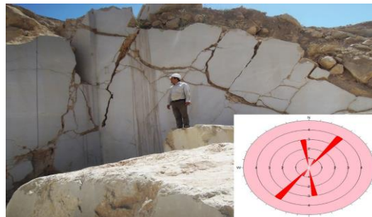
شکل ۶- نمایش سیستم درزه‌های مزدوج که با وجود چند پله استخراج، هنوز اثرات مخرب آنها دیده می‌شود. تصویر مربوط به یکی دیگر از مجموعه معادن مرمریت خوی در استان آذربایجان غربی، جهت دید عکس N143^{\circ} . مطالعات میکروسکوپی بر روی نمونه‌های انتخاب شده نشان می‌دهد (شکل ۷) که نمونه‌های کربناته مرتبط با واحد رسوبی، دگرریختی بسیار جزئی را تحمل و سنگ ساختار اولیه خود را حفظ کرده و اندازه و شکل دانه‌های کلسیت در این نمونه‌ها بیشتر متأثر از خصوصیات اولیه سنگ است. بسیاری از جبهه‌کارها در مسیرها و وضعیت‌های نامناسب، طراحی شده‌اند که این موضوع باعث افزایش میزان خردشدگی شده است. با جابه‌جایی راستای پله‌ها و ابعاد آنها (تغییر در موقعیت و وضعیت جبهه کارها) می‌توان میزان خردشدگی را به میزان قابل توجهی کاهش داد.
