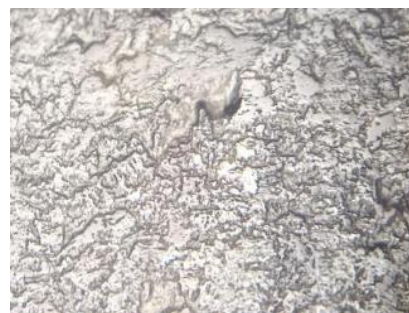
شکل ۷: چند دانه پیریت دانه ریز و بی شکل در زمینه (PPL×100) (نورانعکاسی)
