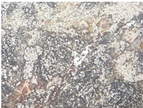
شکل ۱۳: ادخالهای پیریت در ترمولیت - اکتینولیت (XPL x 100)
