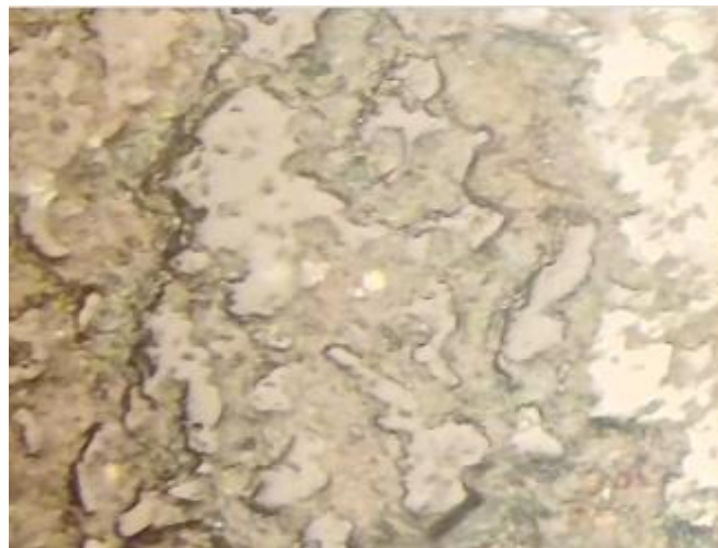
شکل ۲۹: یک دانه بی شکل مشکوک به طلا در نمونه اپیدوت آمفیبول شیبست (PPL×200) (زوم ۵)
