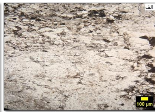
شکل ۴: (آ و ب) دگرسانی سیلیسی سنگ میزبان کرناتی. نور عبوری، PPL و XPL.
