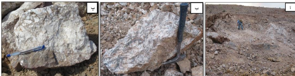
شکل ۲: آ. نمایی از یک توده کانسنگ باریت-فلئوریت-گالن در سنگ آهک دولومیتی در ذخیره جنوب شرق آتشکوه. ب. نمای نزدیک از کانسنگ که حاوی باریت (سفیدرنگ)، گالن (خاکستری تیره) و فلئوریت (خاکستری روشن) است. کانسنگ بافت برشی دارد؛ گالن و فلئوریت در فضاهای بین قطعات برشی باریت دیده می شوند. پ. نمونه کانسنگ باریت-فلئوریت با بافت برشی. فلئوریت در فضای بین قطعات برشی باریت دیده می شود.
