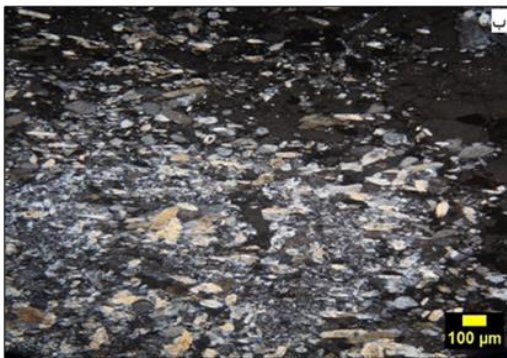
شکل ۴: (آ و ب) دگرسانی سیلیسی سنگ میزبان کرناتی. نور عبوری، PPL و XPL.
