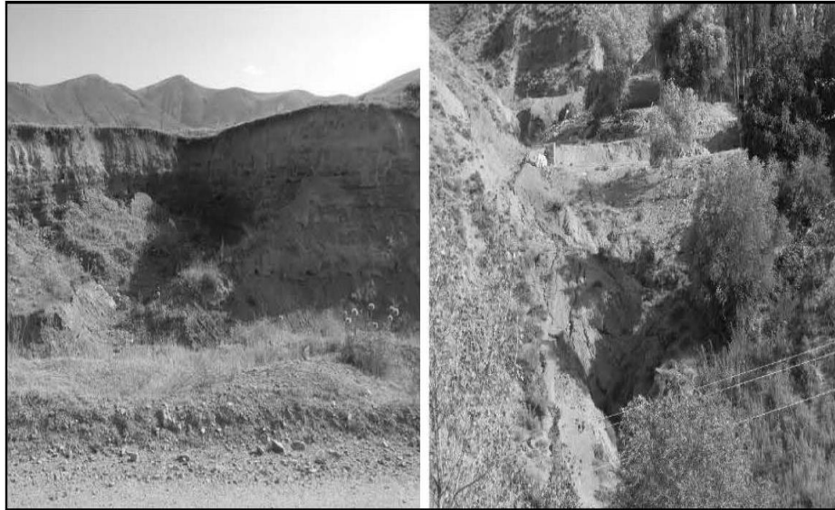
شکل ۸- شواهد میدانی پدیده فرورانشست در پیزومتر و وجود فروچاله‌ها در زمین‌های دشت خوی
