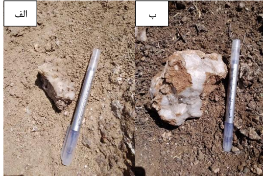
شکل 4- الف: کانی سازی رگه‌ای کوارتز که از سنگ بستر جدا شده است. ب: ژئود کوارتز
