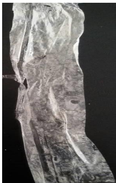
شکل ۴. تصویر فیلم پلی الفینی زیست تخریب شده.
