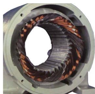
شکل ۴: معیوب شدن یک فاز سیم پیچی
