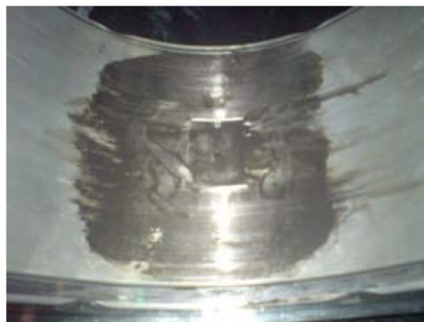
شکل 3: نقص در پوسته پایین بیرینگ هیدرودینامیک
