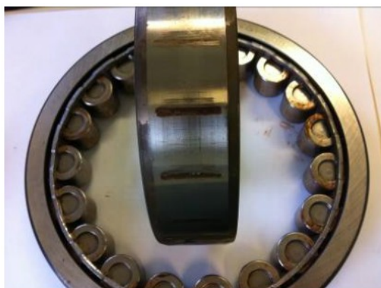
شکل 1: بروز نقص در پوسته داخلی بیرینگ بر اثر لرزش در یک نقطه ثابت
