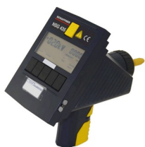
شکل 12: تفنگ مولد تخلیه الکتروستاتیکی ساخت شرکت Teseq مدل [NSG435] 19
