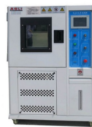
شکل 14 : اتاقک آب و هوایی ساخت شرکت ASLI مدل ]TH-80B ]21
