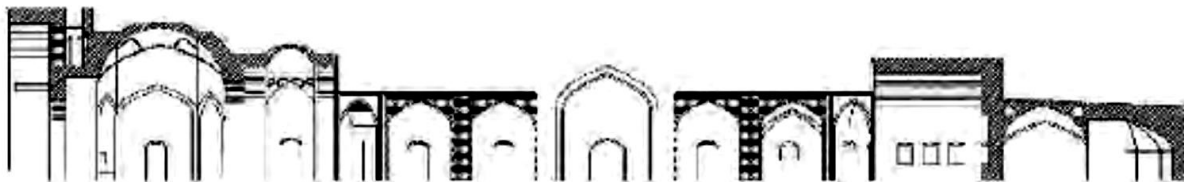
شکل ۱۳- برش عمودی از کاروانسرای جمال آباد، هر کاربری دارای ارتفاع مشخص شده است (منبع میراث فرهنگی استان زنجان).
