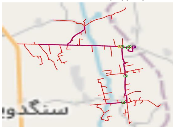
شکل (۱۱) : موقعیت مکانیابی هوشمند برای ریکلوزر با حذف کات اوت فیوزها از تنه اصلی
