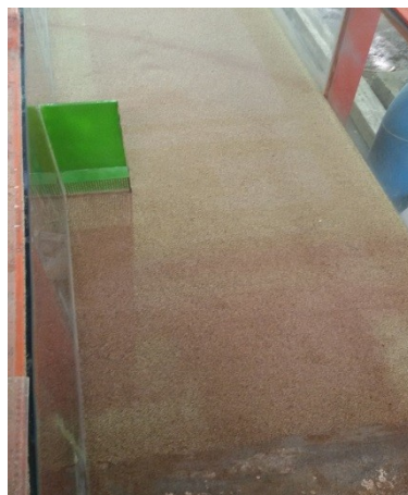
شکل (3) نصب سازه باندال لایک در فلوم پس از تسطیح
