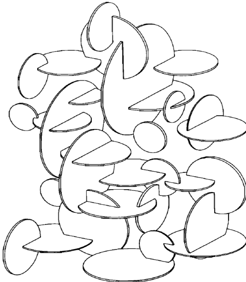
شکل 5- مدل مفهومی از وضعیت درزه های دایره ای نسبت به هم در توده سنگ، [12].
