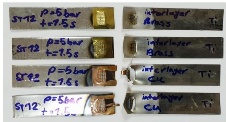
شکل ۶- تصاویر نمونه‌های جوشکاری شده به روش فراصوتی فلز تیتانیوم و فولاد در حضور لایه میانی برنج و مس پس از آزمون کشش
