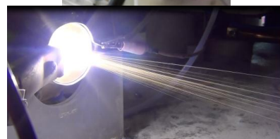
شکل ۲: مشعل پلاسما اسپری طراحی و ساخته شده با کاند تو خالی
