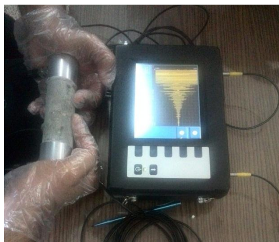
شکل (۳): آزمایش تعیین سرعت عبور موج از مغزه‌های پلاک.
