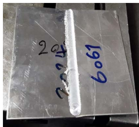
شکل (۶). وضعیت قرار گیری نمونه ها نسبت به یکدیگر (آلیاژ ۶۰۶۱ در سمت پیشرو)
