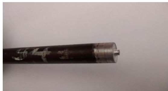
شکل (۳). ابزار جوشکاری اصطکاکی اغتشاشی
