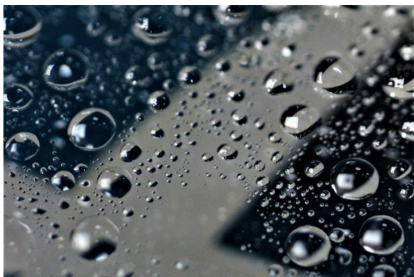
شکل (۱). رفتار شیشه نانو پوشش دهی شده در برابر قطرات باران
