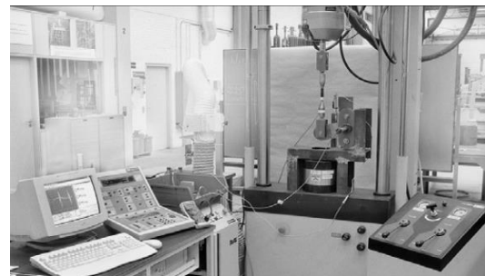
شکل (۶). آزمایش میراگر اصطکاکی دورانی تحت بارگذاری
